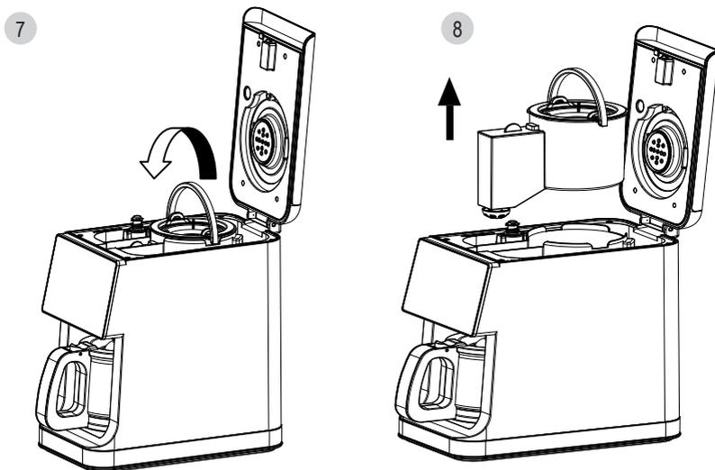
2. Откройте крышку фильтрующей сетки, снимите фильтрующую сетку (например, показано в рис. 9 -рис. 10), сначала поверните к положению, выровненной с логотипом треугольника, а затем поднимите вверх.
