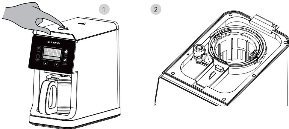
В. Откройте крышку фильтра и вылейте кофейные зерна или молотый в сетку (около 30 г, используя мерную ложку, около 5 ложек зерна или молотого, в среднем около 6 г на ложку). Затем накройте крышку фильтрующей сетки, накройте верхнюю крышку (при закрытии крышки нажмите кнопку на переднее положение поверхности).
